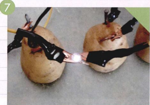
มันสามารถให้ผลิจงานไฟฟ้ากับหลอด LED ได้จริง ๆ ด้วยนะ
