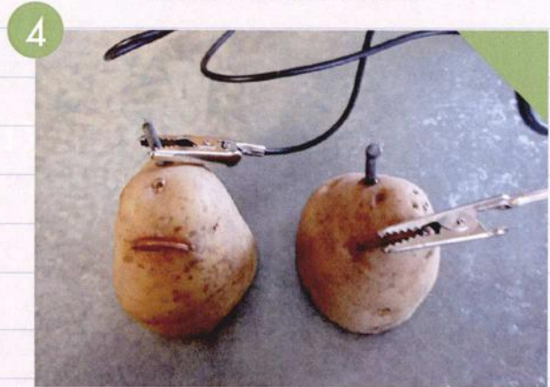
ทดลองเพิ่มมันฝรั่งเป็น 2 ลูกและนำสายไฟมาพ่วงเพิ่ม หนึ่งมันเข้าไป ทดสอบดูว่าจะได้ผลิจงานเพิ่มหรือไม่ ?
