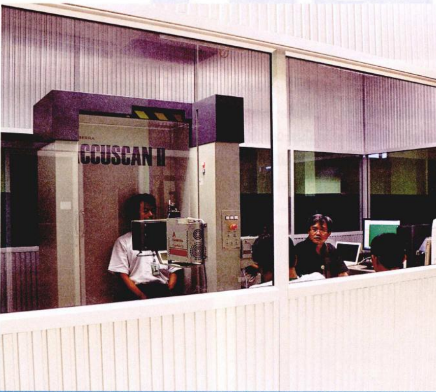
ภาพเครื่องตรวจวัดขณะทำการตรวจวัดรังสีประจำตัวบุคคล สามารถรับรองความปลอดภัยแก่ผู้ปฏิบัติงานเกี่ยวกับรังสี ไม่ว่าจะได้รับจากทางตรงหรือทางอ้อม
