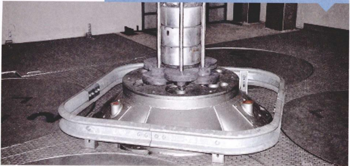
ตัวเครื่องฉายรังสีแกมมา ใช้ต้นกำเนิดรังสีโคบอลต์-60 จำนวนทั้งหมด 6 แท่ง ซึ่งแต่ละแท่งมีความแรงประมาณ 12,000 คูรี ความแรงรังสีรวมทั้งหมด 70,500 คูรี ปัจจุบันความแรงรังสีลดลงเหลือ 49,374 คูรี ผลิตโดยบริษัท Paul Stephens Consultancy Ltd. ประเทศอังกฤษ
