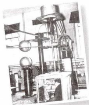
เครื่องเร่งอนุภาคโปรตอนที่ใช้ค็อกครอฟต์และวอลตัน (ในภาพ) ใช้ระดมยิงนิวเคลียสของลิเทียม (ที่มา : http://www.daviddarling.info )
