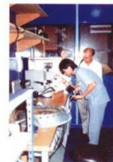
การตรวจสอบล้อเครื่องบินโดยเทคนิคการถ่ายภาพรังสี
