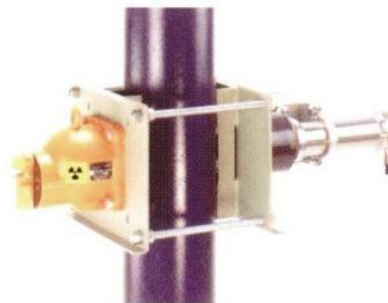
อุปกรณ์ทางรังสีที่ทำหน้าที่ควบคุมความหนาของกระดาษในกระบวนการผลิตกระดาษ
