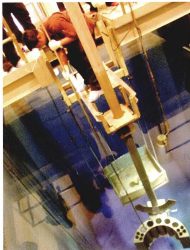
การอบโทแพซด้วยรังสีนิวตรอนจากเครื่องปฏิกรณ์ปรมาณูวิจัย
