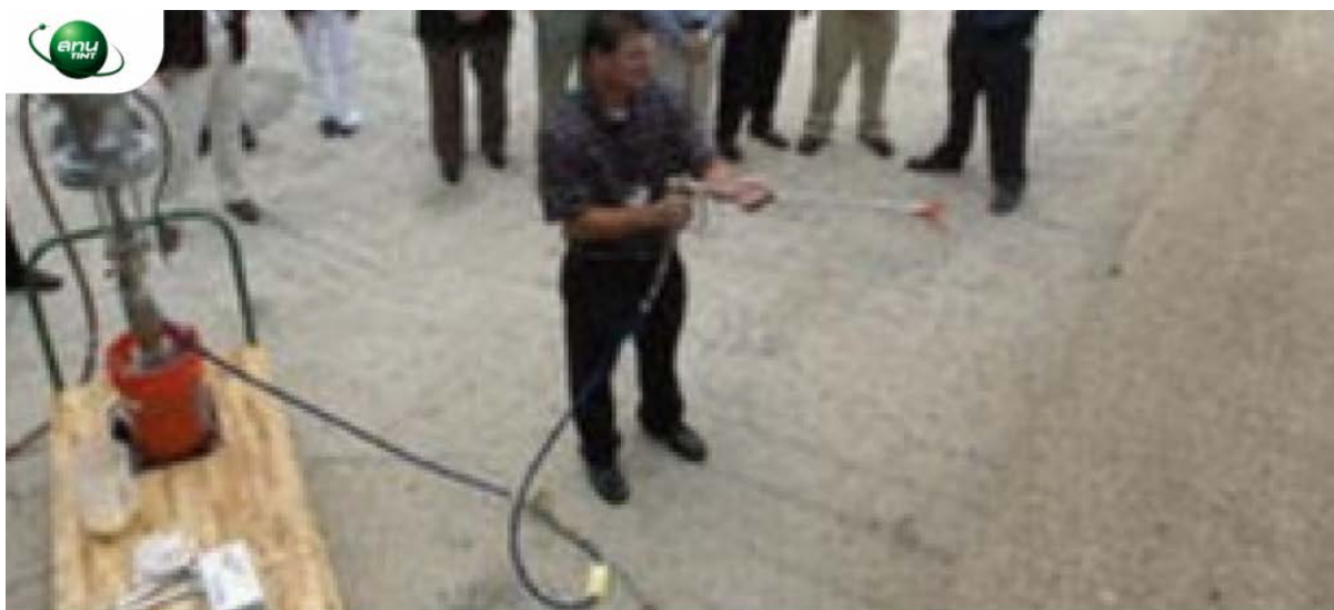
การฉีดพ่น Supergel บนพื้นผิวของคอนกรีตโดยใช้เครื่องมือ ที่หาได้ในท้องตลาด
