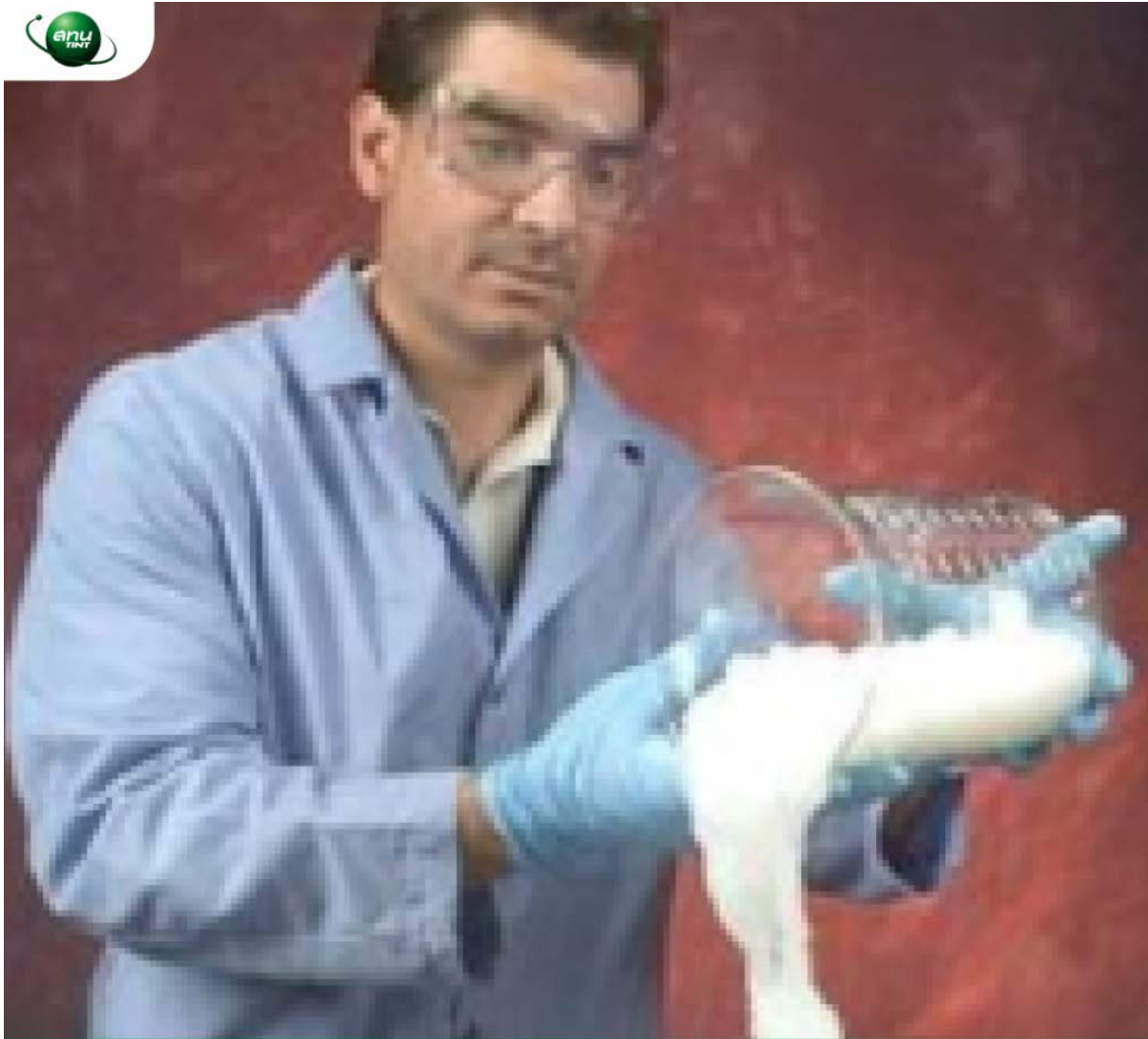
ลักษณะของ Supergel ที่คิดค้นโดยทีมนักวิจัยจาก Agronne National Laboratory เพื่อใช้สำหรับการกำจัดสารปนเปื้อนของสารกัมมันตรังสี บนสิ่งก่อสร้างคอนกรีตหรืออิฐ
